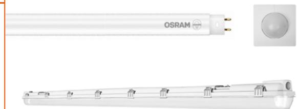
OSRAM SubstiTUBE T8 CONNECTED ADVANCED ULTRA OUTPUT LED-Röhre, installiert im robusten **Damp-Proof-Gehäuse** (IP65), wird via Zigbee kabellos mit **LEDVANCE CONNECTED SENSOR ST8 LOW BAY** verbunden. Eine zweistufige Schaltfunktion (0 % ⇌ 100 % und 20 % ⇌ 100 %) steigert die Effizienz weiter.
