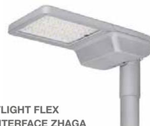
Éclairage modulaire avec interface ZHAGA et des composants de haute qualité. Des performances durables et un éclairage intelligent à l'épreuve du temps pour des routes de classe M, C et P selon la norme EN 13201. IP66, IK08, SK2, très longue durée de vie (L90) : jusqu'à 100 000 h, embouts pour mâts de 42, 48 – 60 et 76 mm disponibles, ouverture du boîtier et bornier à bouton-poussoir sans outil, ULOR 0% lorsqu'il est monté avec une inclinaison de 0°.
